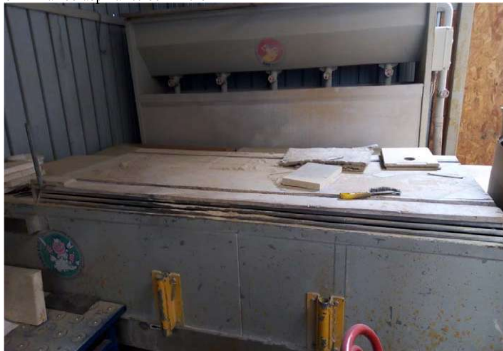
51 – Banco aspirante con filtro
