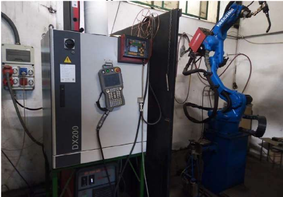
05 – Isola robottizzata su doppia tavola con saldatrice MOTOMAN
