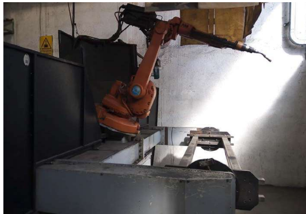
02 – Isola robottizzata a doppio tornio con saldatrice ABB
