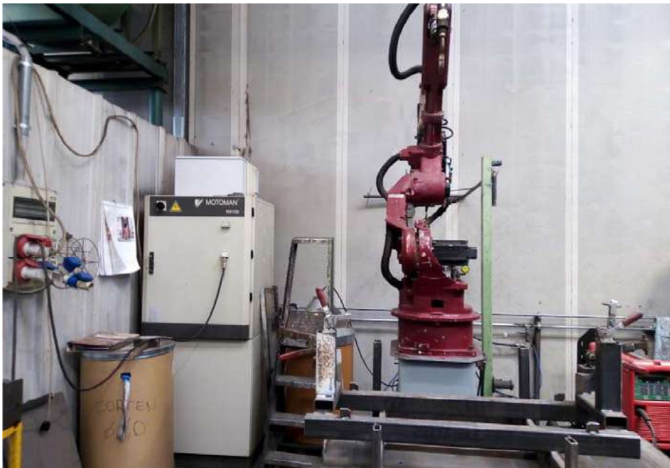
08 – Isola robottizzata su tavola singola con saldatrice MOTOMAN
