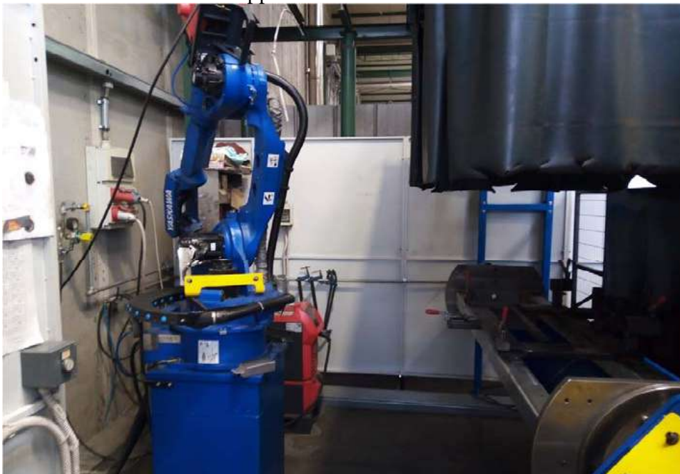
01 – Isola robottizzata a doppio tornio con saldatrice MOTOMAN
